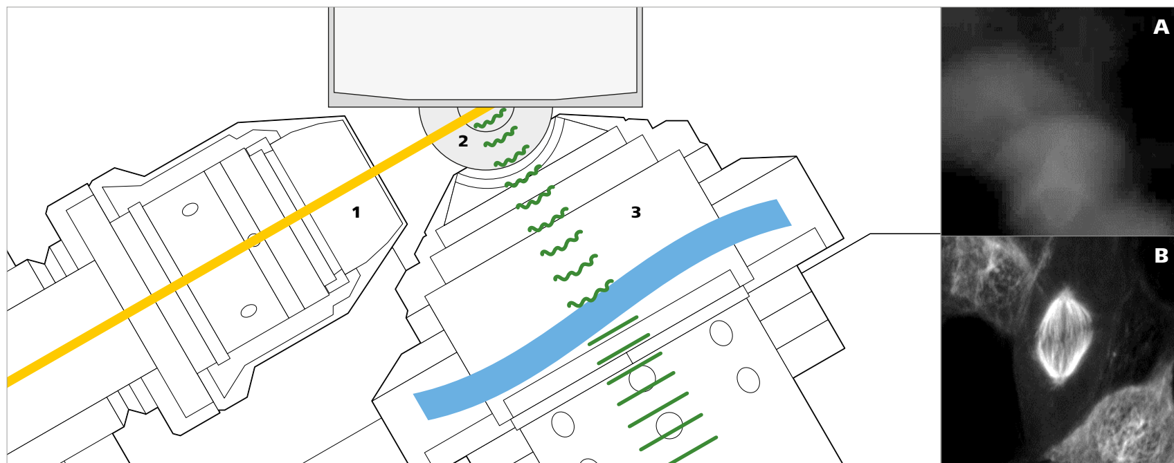
Schema del modulo ottico del portacampione e del nucleo con obiettivo di eccitazione (1), lente menisco (2) e obiettivo di rilevamento con ottiche a forma libera (3). Gli esempi mostrano l'imaging senza (A) e con la correzione delle variazioni dell'indice di rifrazione (B).
