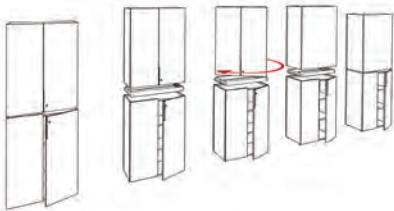
Le librerie e gli armadi composti con spessore intermedio sono reversibili/ Cabinets and wardrobe with intermediate thickness are reversible
