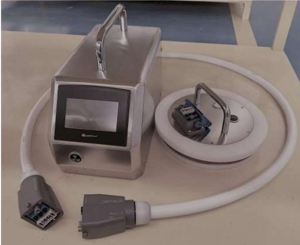
SafeGlove è un sistema per test di tenuta di “Dispositivi di accesso” (i.e. guanti o sistemi di guanti) per isolatori e sistemi chiusi analoghi.
